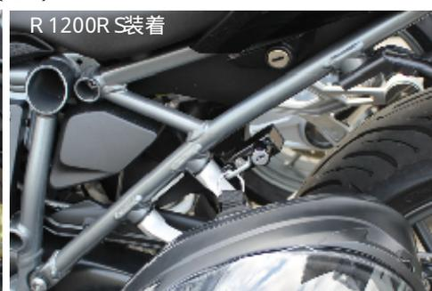
現行の新型 水油冷エンジン搭載 R/R Siに対応したヘルメットロック。タンデムステップに共締めで、使いやすい様にフレームにヘルメットロック本体が設置出来る様にデザインしました。使いやすさを考慮し、違和感なく車体にマッチングした作りがオートバイライフをサポート。
